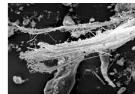
Um diese Fasern geht es bei der Asbestsanierung. Das Rasterelektronenmikroskop macht sie sichtbar und veranschaulicht, wie wichtig der Arbeitsschutz beim Umgang mit dem Stoff ist, der in mikroskopisch kleinen Fasern freigesetzt werden kann. Foto: Competenza Nürnberg
