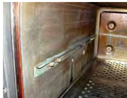
Korrodiertes Sterilisator: Rost auf den OP-Instrumenten folgte.
