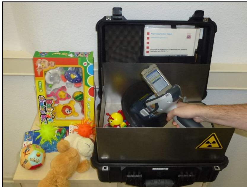
Abbildung 1: RFA-Analyse vor Ort
