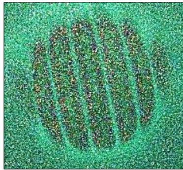
Abbildung 3: Polverlauf eines Magneten
