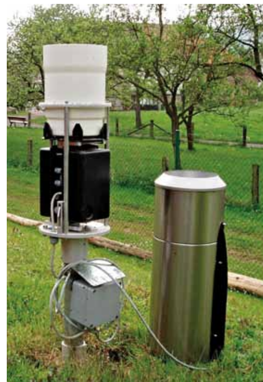
Ein Blick ins Innere einer Niederschlagsmessstelle. An 17 Stellen im Regierungsbezirk Kassel werden die Niederschlagsmengen erfasst.
