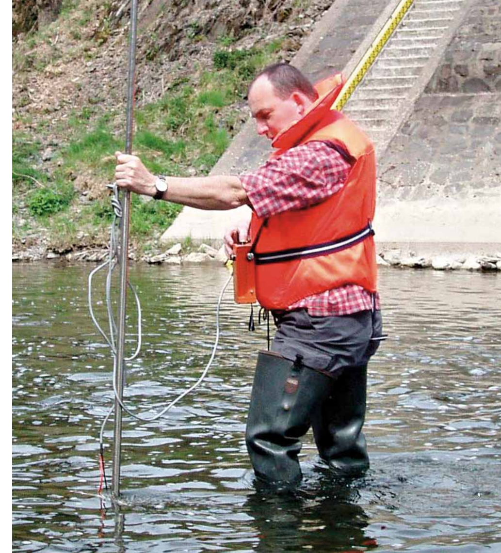
Andreas Grzywotz bei einer Abflussmessung mit einem Stangenflügel am Pegel Auhammer. Fotos: RP
