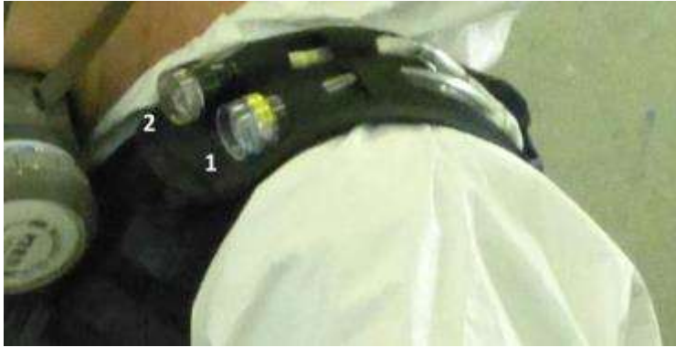
ABBILDUNG 6: PARALLELE PROBENAHME VON LACKAEROSOLEN (PROBENAHMEKOPF; 1) UND LÖSEMITLEN (TENAXRÖHRCHEN MIT VORGESCHALTETEM GLASFASERFILTER; 2) BEIM SPRITZLACKIEREN
