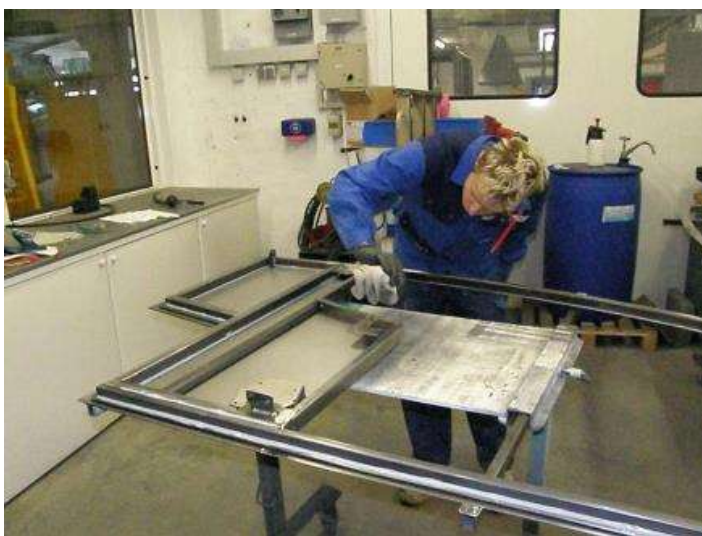
ABBILDUNG 1: ABWISCHEN VON WERKTEILEN MIT LÖSEMITTELHALTIGEM REINIGER
