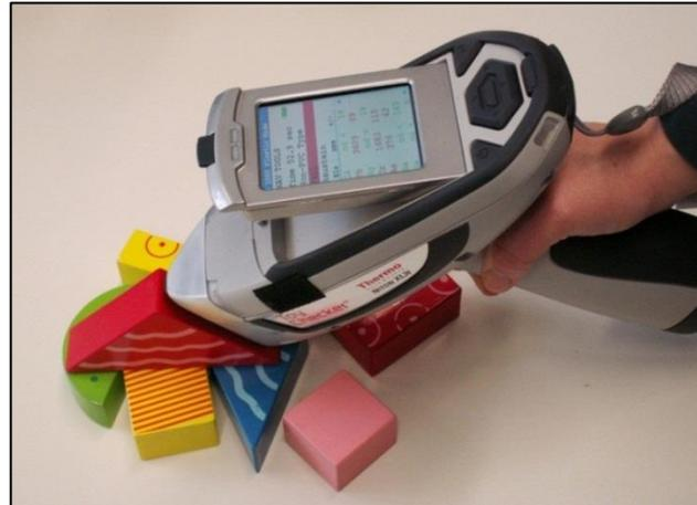
Abbildung 3: Röntgenfluoreszenzanalysator (RFA)
