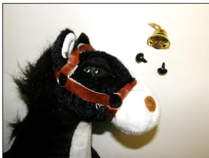
Abbildung 4: Verschluckbare Kleinteile nach der Zugprüfung
